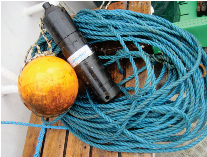
Figur 44. En hydrofonboj VR2 med flytkula och ankringslina (foto Ingvar Lagenfelt).
