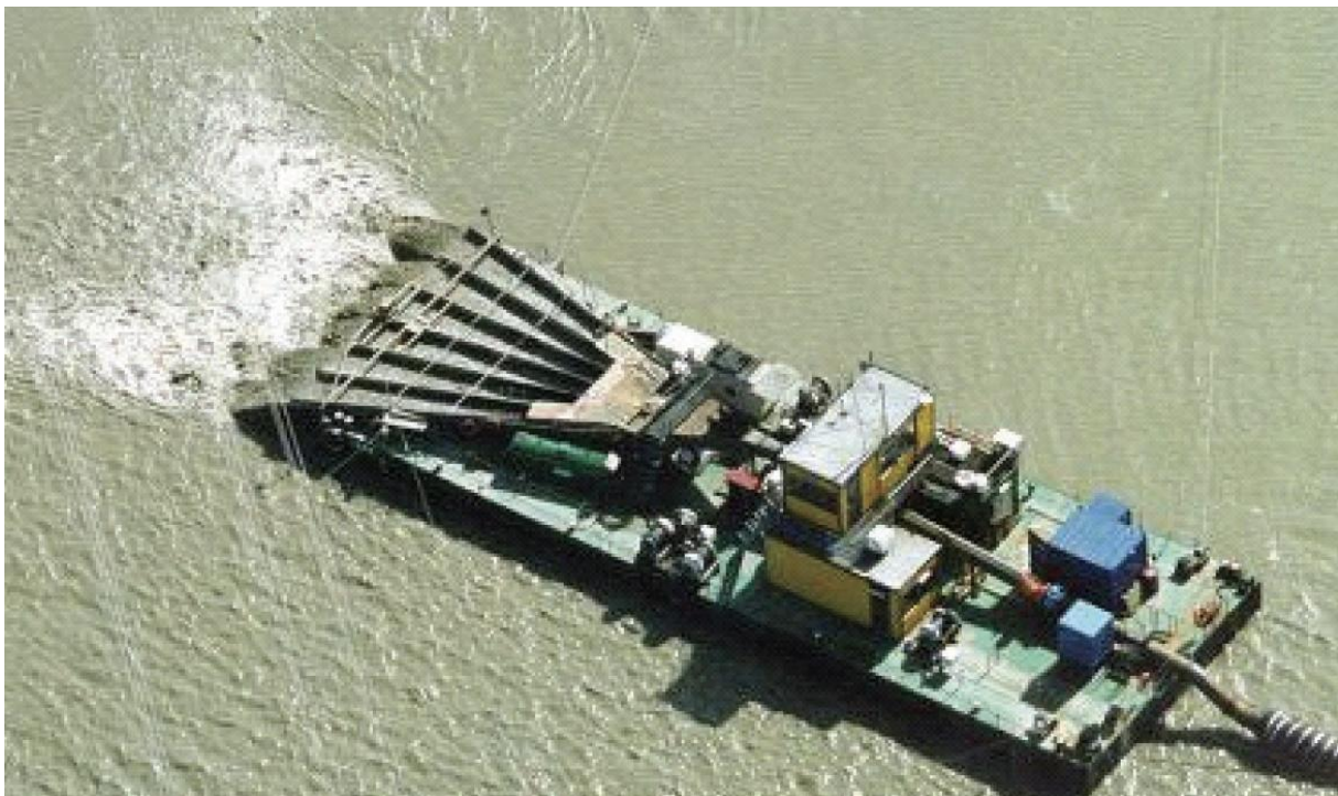
Figur 7. Automatiserad sandspridningspråm (bild från Bailey m.fl. 2005).
