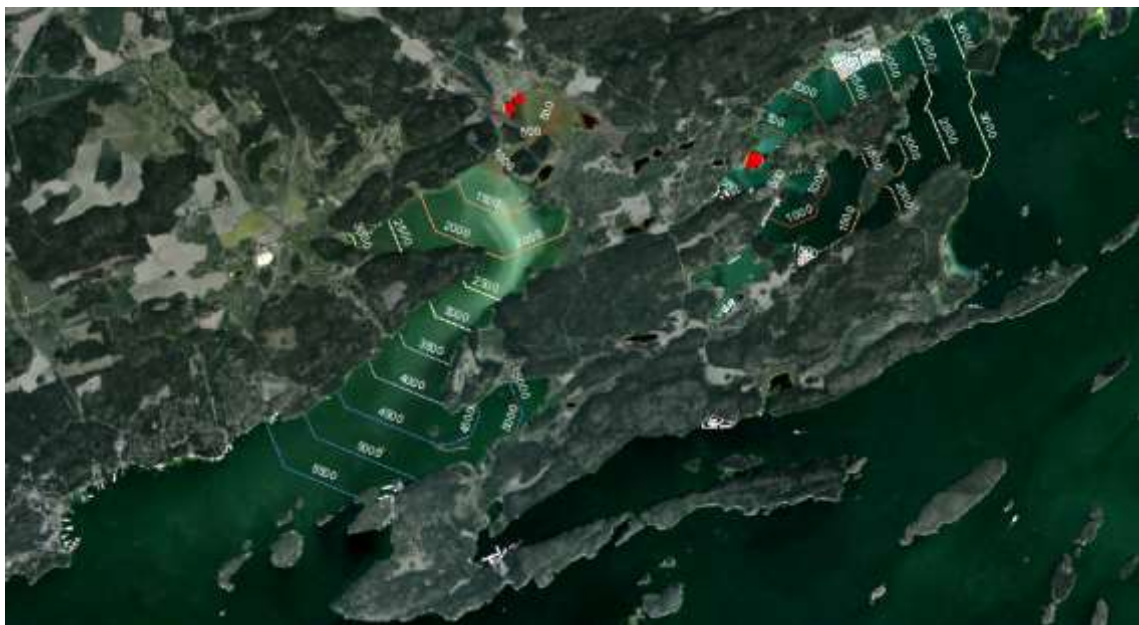
Figur 57. Muddringsplym, Väterhaninge-Gålö. Plymen förs iväg av ett vattendrag och når över 5000 meter.
