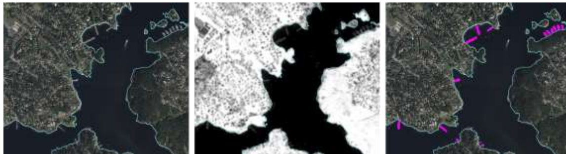
Figur 37. Resultat från kartläggning av artificiella objekt med satellitdata. Strandlinjen (till vänster) i blått, i mitten NDVI-värden och till höger visas karterade objekt i rosa.
