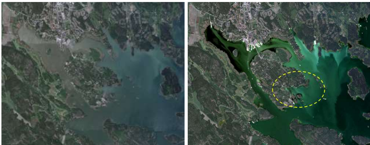
Figur 52. Ofta är det svårt att i flygbildsmosaiker tolka olika typer av grumlingar och skilja alger från suspenderad silt. Till vänster visas en flygbild över Trosaåns mynning. Till höger visualiseras en kontraststräckt RGB-bild från Sentinel-2 (2015-08-13) som ganska tydligt visar grumlingen från muddringar i bildens hägra kant (turkosgrönt, inringat område) till skillnad från grumling och algblooming som härrör från näringsrik avrinning från åkermark via trosaån (grönt i bilden).
