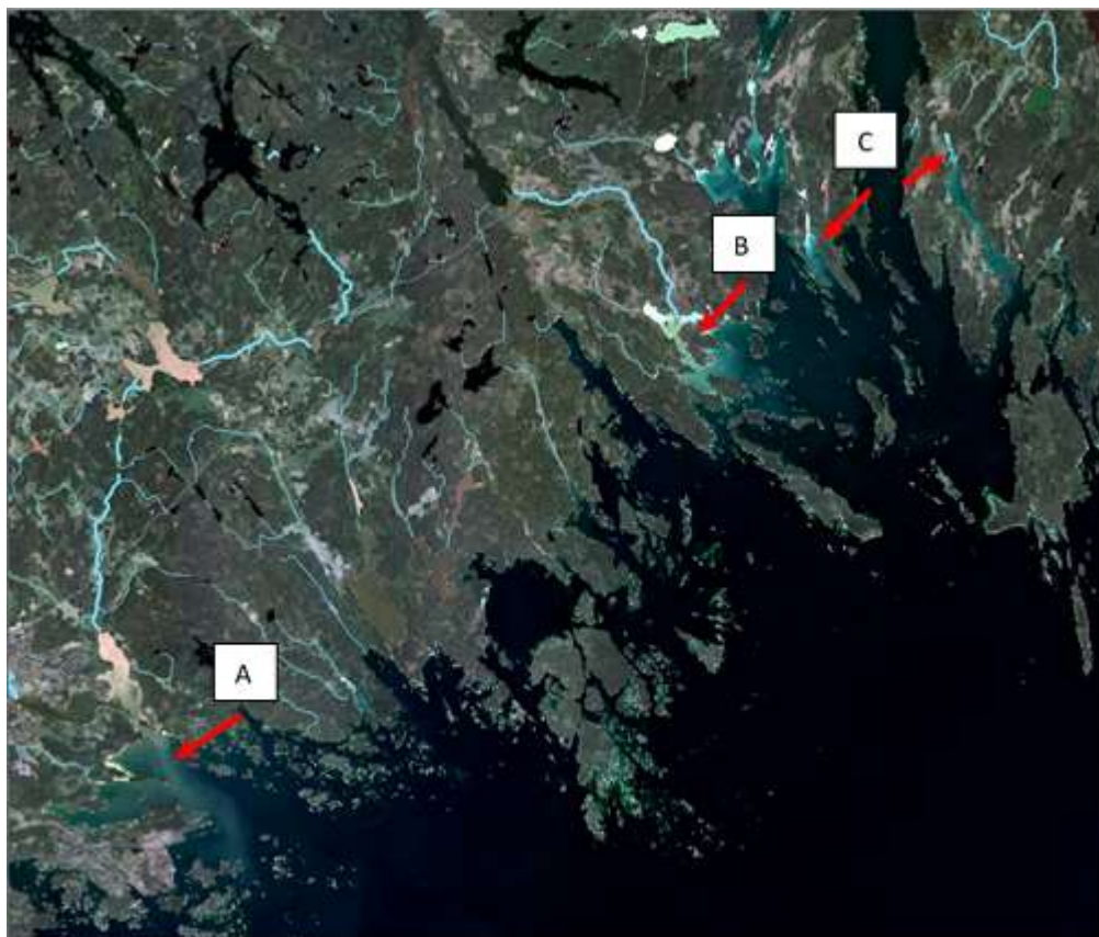
Figur 54. Vårbild (20160412) i vilken tydligt framgår avrinning från Svärtaån (A) och Trosaån (B) samt mindre muddringar från mindre vattendrag. I vårbilden syns även resuspension från föregående års muddringar (C).
