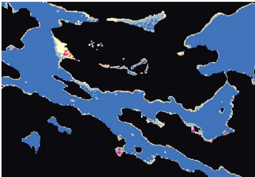
Figur 46. Differensen mellan reflektans i rött band för ett visst datum mot minimivärdet för samma år i detta frekvensband, vilket alltså visar aktuell bils anomali mot ett förväntat "normaltillstånd" med minimal grumling. Tre muddringar som rosa stjärnor, två har viss indikation på muddring medan en har en kraftig indikation. Samma område och muddringar som i Figur 45 ovan.
