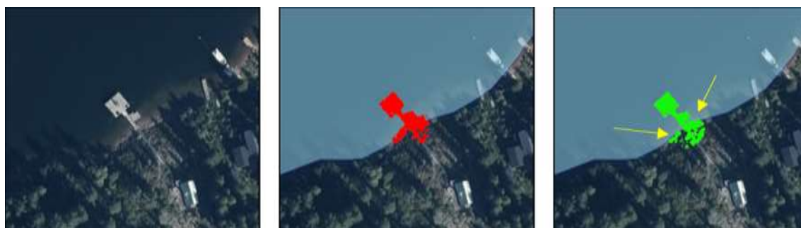
Figur 38. Avgränsning av brygga med hjälp av ortofoto-mosaik. Till vänster: bryggan i RGB-ortofoto. I mitten avgränsad med hjälp av röda bandet och till höger med hjälp av NIR. Resultatet måste maskas bort med vattenmask, inlagd som referens i bild 2 och 3. Notera den något mindre blödningen i trösklingen i NIR, närmast land (gul pil) i bild till höger.
