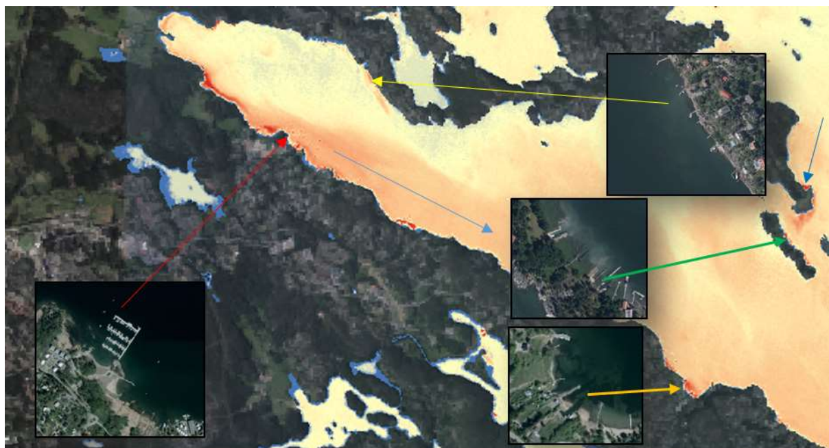
Figur 51. Med röd pil visas källan till en mycket stor (närmare 15 km lång, det orange-röda fältet) plym av grumling som i alla fall delvis synes härröra från uppförandet av en större småbåtshamn och dumpning av muddermassor i vattnet. Den mellanstora grumlingen, gula pilen, (600 x 85 m) har orsakats av en enskild muddring. Båda dessa av samma årtal som satellitbilden. Vid grön pil några mindre muddringar som syns i satellitanalysen som näst intill ströpixlar. Dessa har muddrats innan året 2006 respektive åren 2012 och 2014. Vid blå pil syns i 2017 års ortofoto att fastighetsägaren år 2015 röjde vass, alger och stenar vid sin sandstrand. Vid orange pil några mindre muddringar som är äldre, senaste tydliga muddring år 2011. De grumlar fortfarande, om än lokalt.
