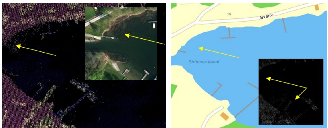
Figur 10. Vassbälten (gul pil) kan detekteras bara i de sällsynta fall där de är klassade som vatten eller är oklassade i laserdata, som i fallet ovan. Infällt ortofoto som visar vassen, i fastighetskartan t.h. visas att ytan betraktas som vatten och punkterna i laserdata blir då "oklassade" och kan skiljas ut som anomalier, liksom bryggorna (se nedre delen av bilden) som har högre intensitet. Skillnad i intensitet framgår av infälld bild t.h.
