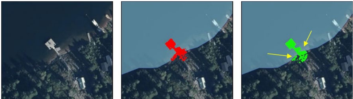
Figur 13. Avgränsning av brygga med hjälp av ortofotomosaik. T.v. bryggan i RGB-ortofoto. I mitten avgränsad med hjälp av röda bandet och t.h. med hjälp av NIR. Resultatet måste maskas bort med vattenmask, inlagd som referens i bild 2 och 3. Notera den något mindre blödningen i trösklingen i NIR, närmast land (gul pil), ovan t.h.
