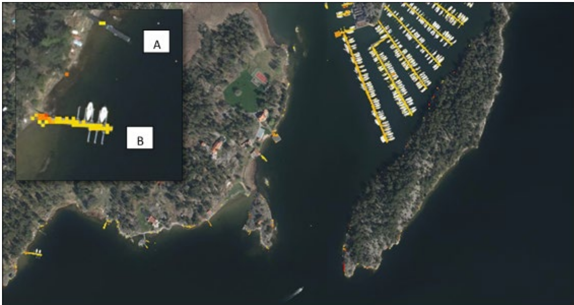
Figur 9. Detektion av bryggor med LiDAR-data. Pixlarnas höjd över noll-linjen i gradienten gul (0,4 m) till rött (2,94 m). A: För att ta bort vågor sattes en tröskel vid 0,4 m höjd, varför denna flytbrygga filtrerades bort. Denna tröskel skulle kanske kunna tas bort om tröskeln i intensitet sätts strängt. B: Y-bommarna detekteras inte eftersom de är för små. Område vid Bullandö marina.
