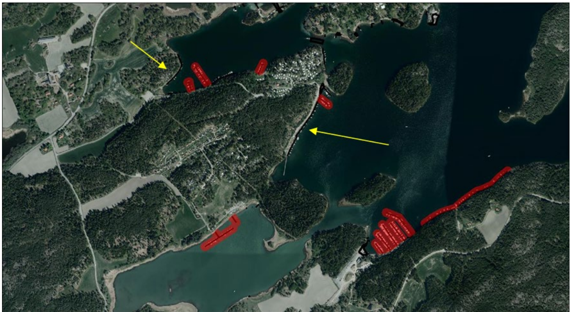
Figur 6. Exempel på behov av metodförfining. I bilden ovan finns två strandnära längsgående bryggor (gula pilar) som ej kommer med i hamnanalysen eftersom de ej detekteras i aktuell metod och ej heller är karterade sedan tidigare. Här måste metoden kunna fånga upp långa bryggor längs stranden och exkludera korta sådana.
