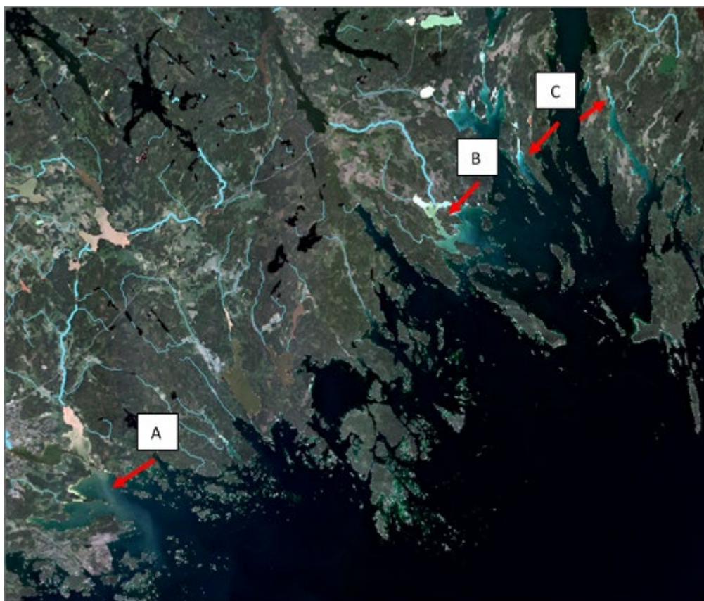
Figur 15. Vårdbild (20160412) i vilken tydligt framgår avrinning från Svärtaån (A) och Trosaån (B) samt mindre muddringar från mindre vattendrag. I vårbilden syns även resuspension från föregående års muddringar (C).
