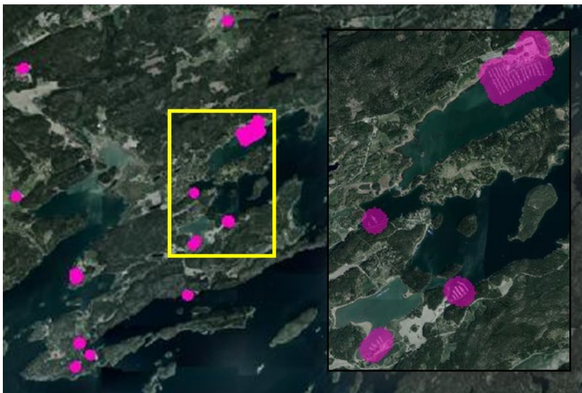
Figur 8. Den automatiska algoritmen som tar fram molnmasker i MATS identifierar felaktigt bryggkomplex i vattnet som moln, varför viktiga områden systematiskt exkluderas. "Moln" som rosa områden i bilden ovan.
