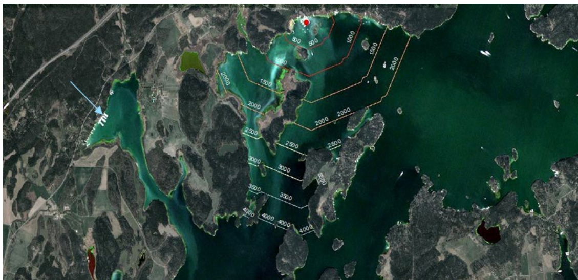
Figur 19. Muddringsplym, Söderby norr om Muskö, omkring 4000 m lång. Grumlingen till vänster i bilden har inte kunnat identifieras som muddring men troligtvis härrör grumlingen från en muddring invid bryggorna (pilen).
