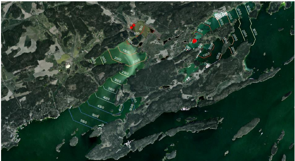
Figur 18. Muddringsplym, Västerhaninge-Gålö. Plymen förs iväg av ett vattendrag och når över 5000 m.
