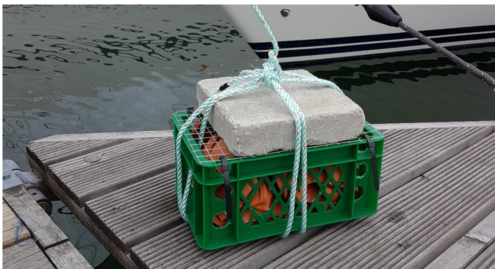
Figur 6. Artificiellt habitat innan utsättning. Fyllnadsmaterialet består av krukskärvor och ett metallnät täcker ovansidan. Stenen användes som tyngd.
