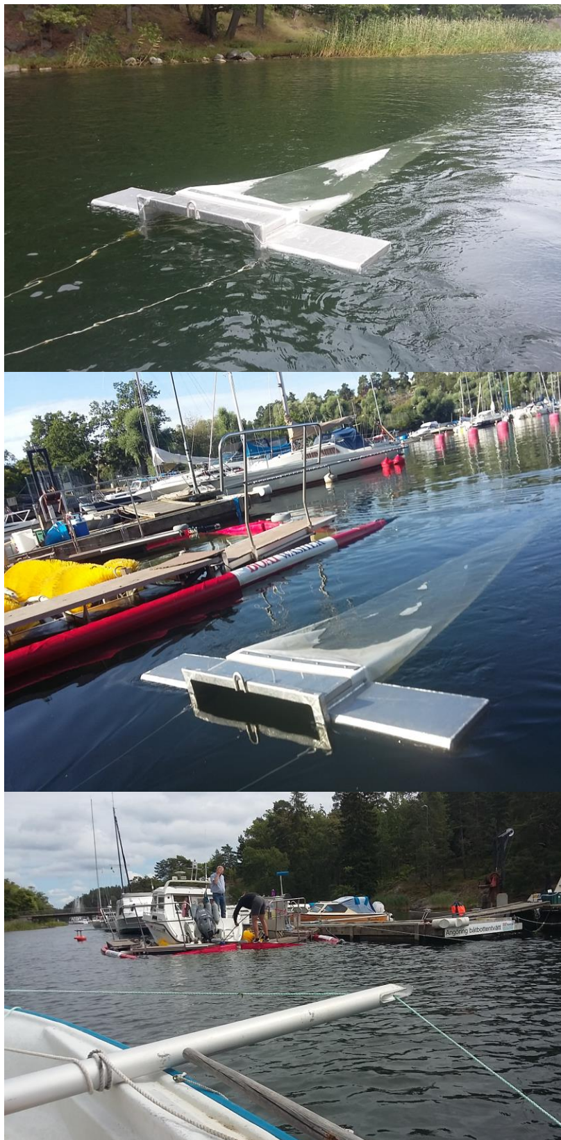
Figur 8. Foto på mantatrålen (maskstorlek 300 \mu m) vid provtagning vid Bosön, Lidingö, samt Fisksätra. På nedre foto syns den bom som höll trålen ut från sidan från provtagningsbåtarna. Notera att hörnen på båttvättanläggningen hänger under vattenytan.
