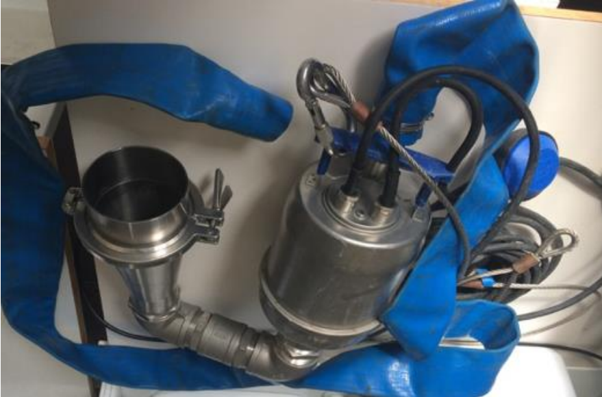
Figur 9. Foto på dränkbar pump för in situ filtrering. 300 \mu m nylon nät fästs i tratten som syns till vänster. Nätet är det första som möter partiklarna vilket minimerar kontamination. Design F. Norén, N-research.
