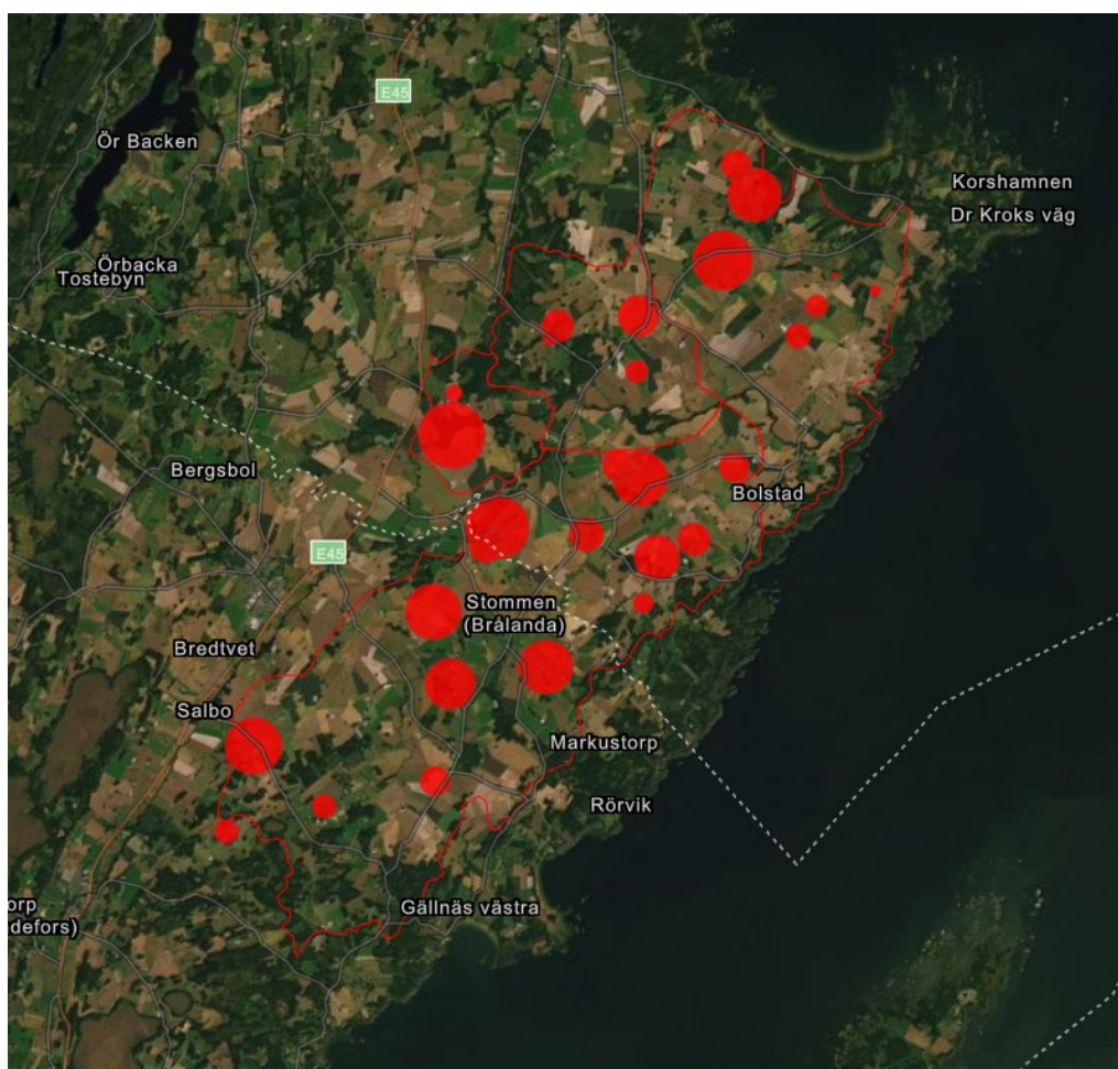
Figur 20. Fosfordammarnas placering i delområde Lillån 4596, Lillån 4568 och Lillån 4563. Storleken på cirklarna representerar den relativa fosforreduktionens storlek i kg P/ha. Placeringen av fosfordammarna är en modellberäkning avsedd att ge dammarna en optimal placering med hänsyn taget till dammens area och hydraulisk belastning. Placeringen har inte kontrollerats i fält.
