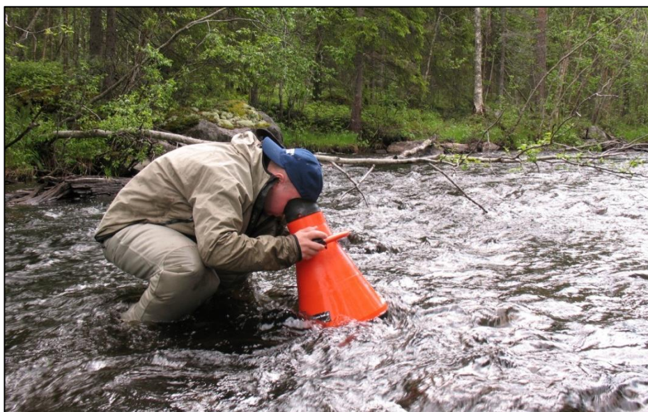
Vid undersökning av flodpärlmusslor räknas beståndet med hjälp av vattenkikare. På ett slumpmässigt urval sker också längdmätning. Foto: Tommy Vennman.
