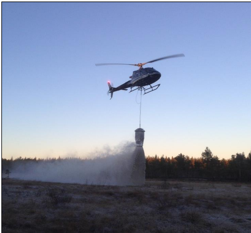
Drygt hälften av kalkspridningen sker med helikopter på sjöar eller på våtmarker. Valet av spridningsområden är helt avgörande för effekten. Foto: Mats Lindberg, SMA mineral.
