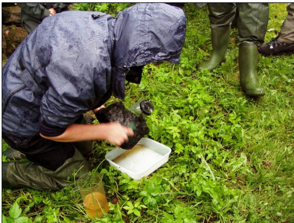
Vid provtagning av påväxtalger insamlas material från 5-10 stenar. Insamlingen görs genom att stenarna skrubbas med en vanlig tandborste. Foto: Lajla Lindgren.
