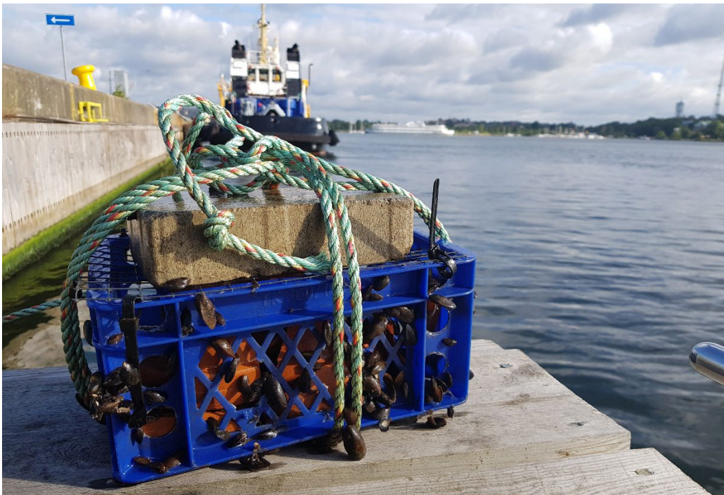
Artificiellt habitat i Karlskrona vid upptagning. Fyllnadsmaterialet består av krukskärvor och ett metallnät täcker ovansidan. Stenen användes som tyngd. Foto: Marine Monitoring AB.
