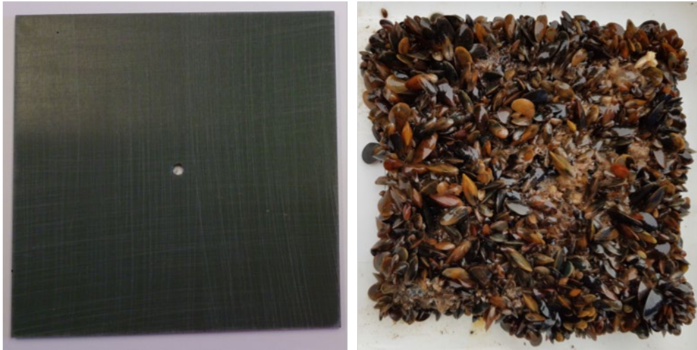
Figur 3. Plattor från påväxtpaneler. Vänster: Platta från påväxtpanel innan utsättning. Höger: Platta från en påväxtpanel i Halmstad hamn efter tre månader, påväxten domineras av blåmusslor ( Mytilus edulis ). Foto: Marine Monitoring AB.
