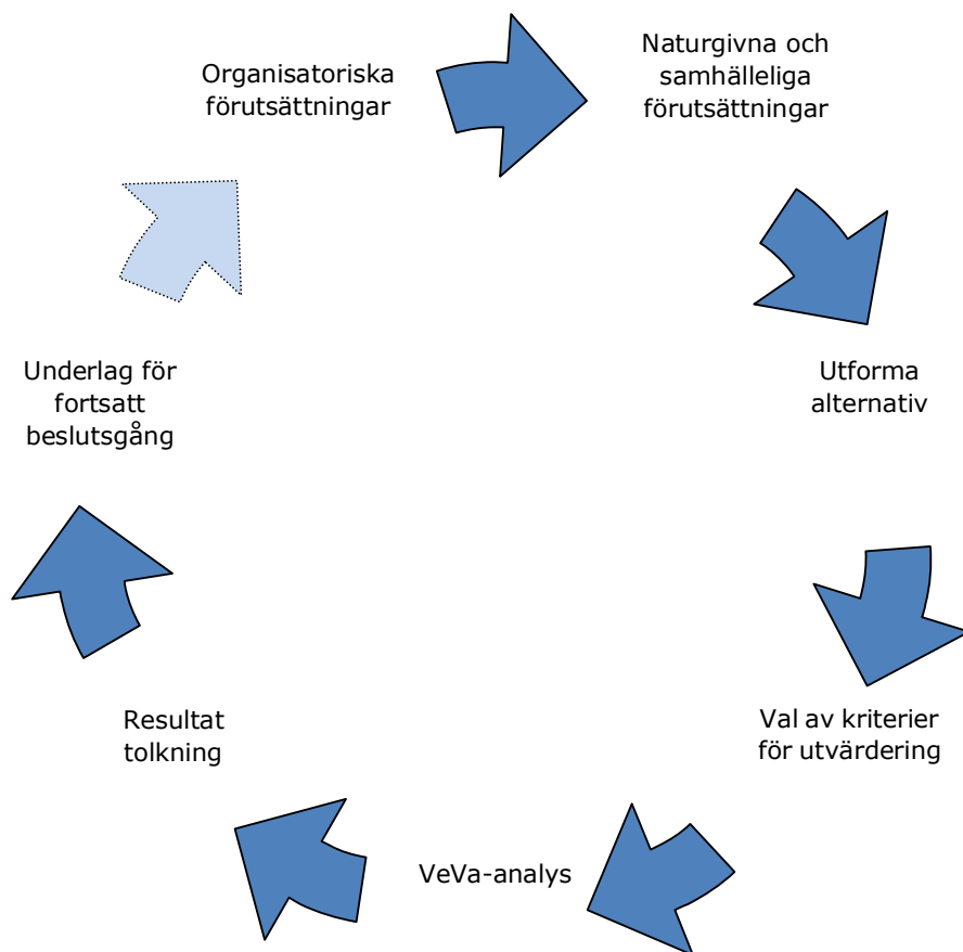
Figur 1. Generell arbetsgång för tillämpning av VeVa i den kommunala planeringsprocessen för val av VA-system. Arbetsgången startar med fördel i Organisatoriska förutsättningar och kan ses som en iterativ process.
