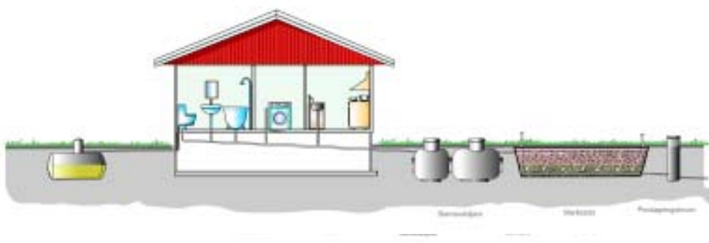
Figur 15. Principskiss för avloppsanläggning med urinsortering och behandling av urinavlastat avloppsvatten i markbädd.
