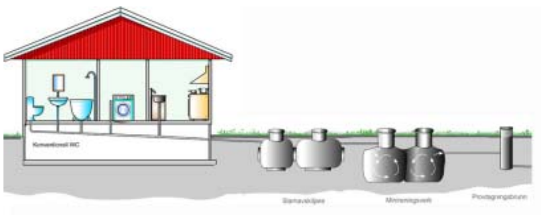
Figur 20. Principskiss för avloppsanläggning med minireningsverk. Detta bör följas av efterbehandling i resorptionsdike eller motsvarande vilket inte visas i bilden..
