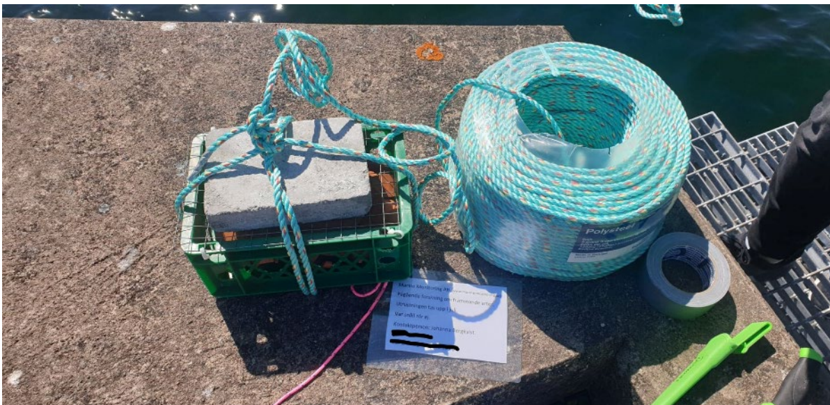
Figur 2. Artificiellt habitat innan utsättning. Fyllnadsmaterialet består av krukskärvor och ett metallnät täcker ovansidan. Stenen användes som tyngd. Foto: Marine Monitoring AB (CC BY).
