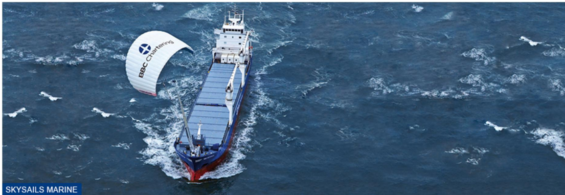
Figur 12. Företaget Skysails har som affärsidé att utveckla segel till kommersiella fartyg som komplement till traditionell framdrift (Källa: Skysails GmbH).
