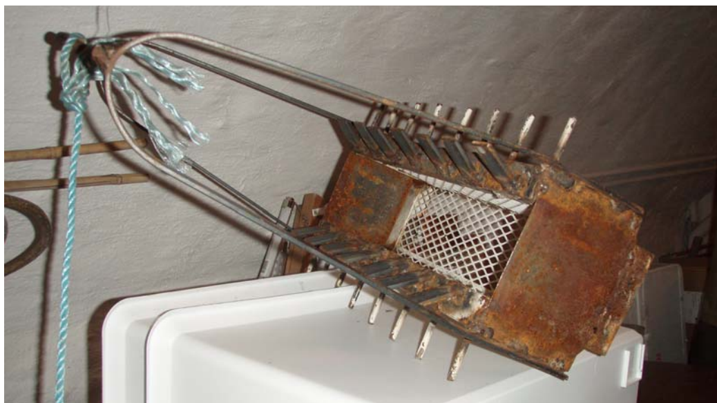
Figur 3. Karlssonkrattan utvecklat av Johan Karlsson, Calluna AB. Krattan har inga normmått. Ska en kratta av typ karlssonkratta byggas bör dock beaktas att föremål placeras vid krattans öppning (metallstift och metallplattor) som river upp framför allt isoetider (rosettbladsväxter) så att dessa fastnar i krattan. Maskdiametern hos krattans långsidor bör inte vara större än 1 cm. Foto taget av Johan Karlsson.
