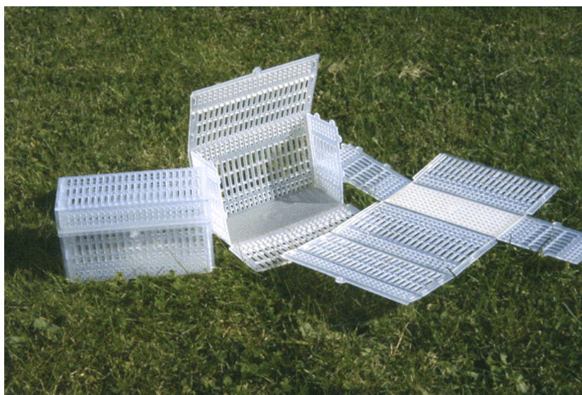
Figur 9. Sedimentfälla tillverkad av en Whitlock-Vibertask. Asken till vänster är färdig för användning. De andra är i olika stadier av hopvikning.
