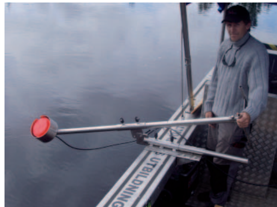
Figur 4. Fästeanordning för ekolodets transduktor för horisontell ekolodning. Anordningen tillåter justering i djup liksom i horisontell och vertikal riktning, samt kan monteras på båda sidor av båten.
