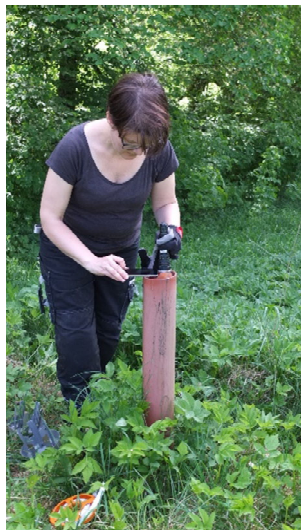
Figur 3 Inspektion av luftningsrör med ficklampa
