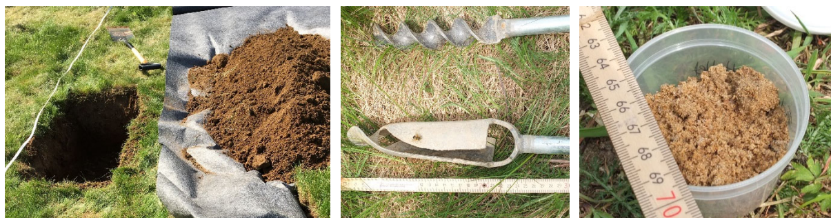
Figur 4 Grävd grop ner till spridarlagret (vänster), grov jordborr (nedre) och spiralborr (övre) som användes vid provtagning av sandmaterial från förstärkningslagret (mitten) och sandprov från förstärkningslagret (höger).
