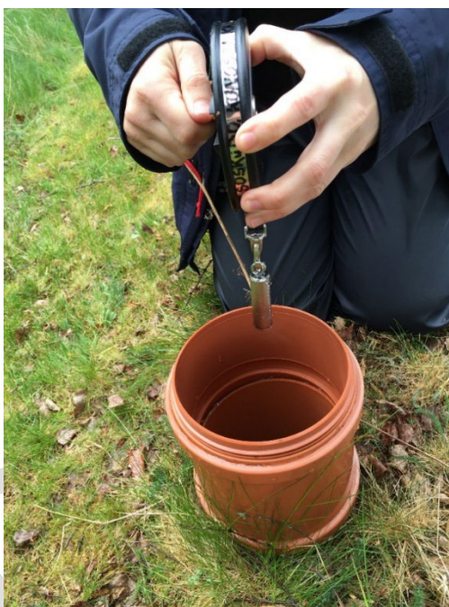
Figur 62 Mätning med klucklod i grundvattenrör vid en avloppsanläggning
