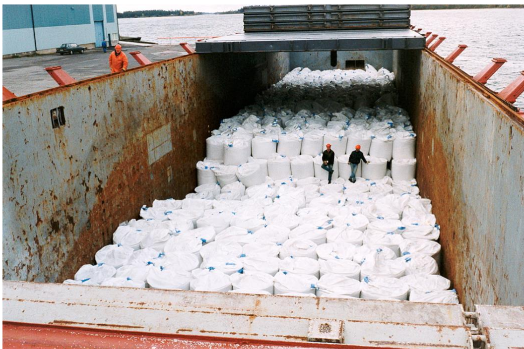
Kalkning av sjöar och vattendrag är en omfattande verksamhet med brytning, bearbetning, transport och spridning av 100 000 ton kalk/år. Fotot visar ett fartyg lastat med kalkgranuler på väg från Tyskland till Västerbotten. Varje säck rymmer 1,5 ton kalk. Foto: Sten Ullerud, OMYA.
