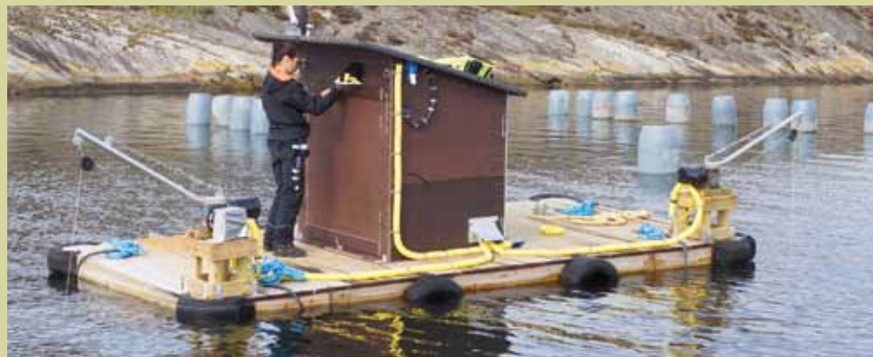
En flotte användes som mätplattform vid studien i Tångesund, Orust. Automatiska vinschar förflyttade undervattensmikroskop och andra mätinstrument till olika djup och internetuppkoppling gjorde det möjligt att skicka data i så gott som realtid.
