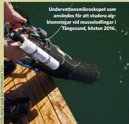
En flotte användes som mätplattform vid studien i Tångesund, Orust. Automatiska vinschar förflyttade undervattensmikroskop och andra mätinstrument till olika djup och internetuppkoppling gjorde det möjligt att skicka data i så gott som realtid.
