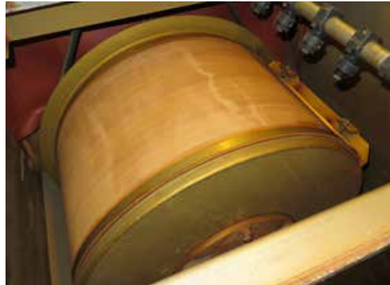
Figur 16. Två olika typer av trumfilter för borttagning av tyngre partiklar och slam i RAS anläggning. Filtret till höger består av mässing för att tåla saltvatten bättre.
