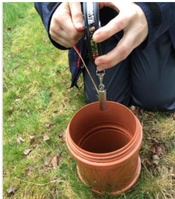
Bild 8 Mätning med klucklod i grundvattenrör
