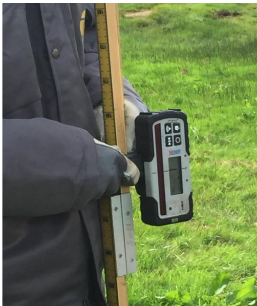
Bild 11 Mottagare med mätsticka för planlaser
