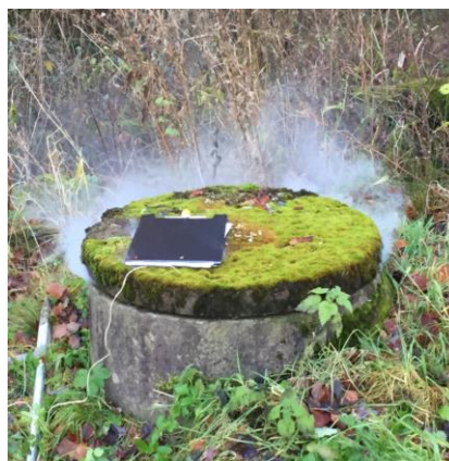
Bild 7 Ventilationstest med rökpatron i slamavskiljare.
