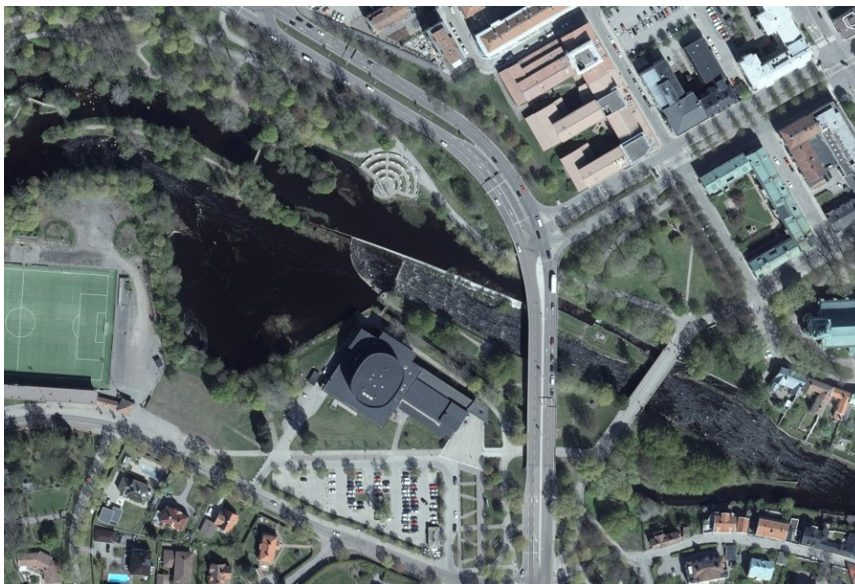
Figur 17. Fiskpassage i form av ramp/upptröskling inom vattendraget där utrymmet är begränsat. Här vid konserthuset i Gävle. Foto: Mattias Olsson, Länsstyrelsen Västernorrland.
