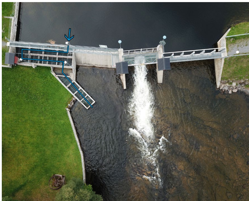
Figur 4. Placering av ingången på den djupa sidan ökar chansen att fisken ska kunna hitta ingången till passagen. I detta fall saknas dock tydligt anlockningsflöde vilket skulle behöva tillföras under vandringsperiod. Foto: Mattias Olsson, Länsstyrelsen Västernorrland.
