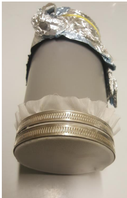
Figur 2. Ett 300 µm nät fästes vid individuella polypropylenrör som förberedes i lab och sedan fästes direkt vid trålnätet med hjälp av slangklämmor. (Bild: Therese Karlsson)
