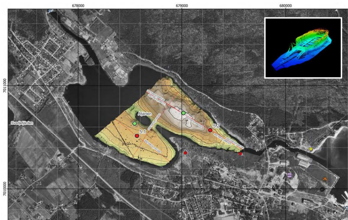
Figur 76. Karta från hydroakustisk undersökning med multistrålande ekolod (MBES) i Åfjärden, Västernorrland. Stora bilden visar ortofoto från 2001 med det inmätta området (relativ färgskala för djup: ljusgrönt = grunt, vitt = djupt), föreslagna provlokaler (röda punkter) och slutliga provpunkter (gröna punkter). Kartan visar även riskklassade förorenade områden (EBH-objekt) och områden där släckning med brandskum genomförts (eldsymboler) på land. Den lilla bilden uppe i högra hörnet visar strukturen på ett föremål som kartlades på botten, troligtvis en ångråm cirka 22 m lång (relativ färgskala för djup: ljusrött = grunt, blått = djupt). (SGU 2023)
