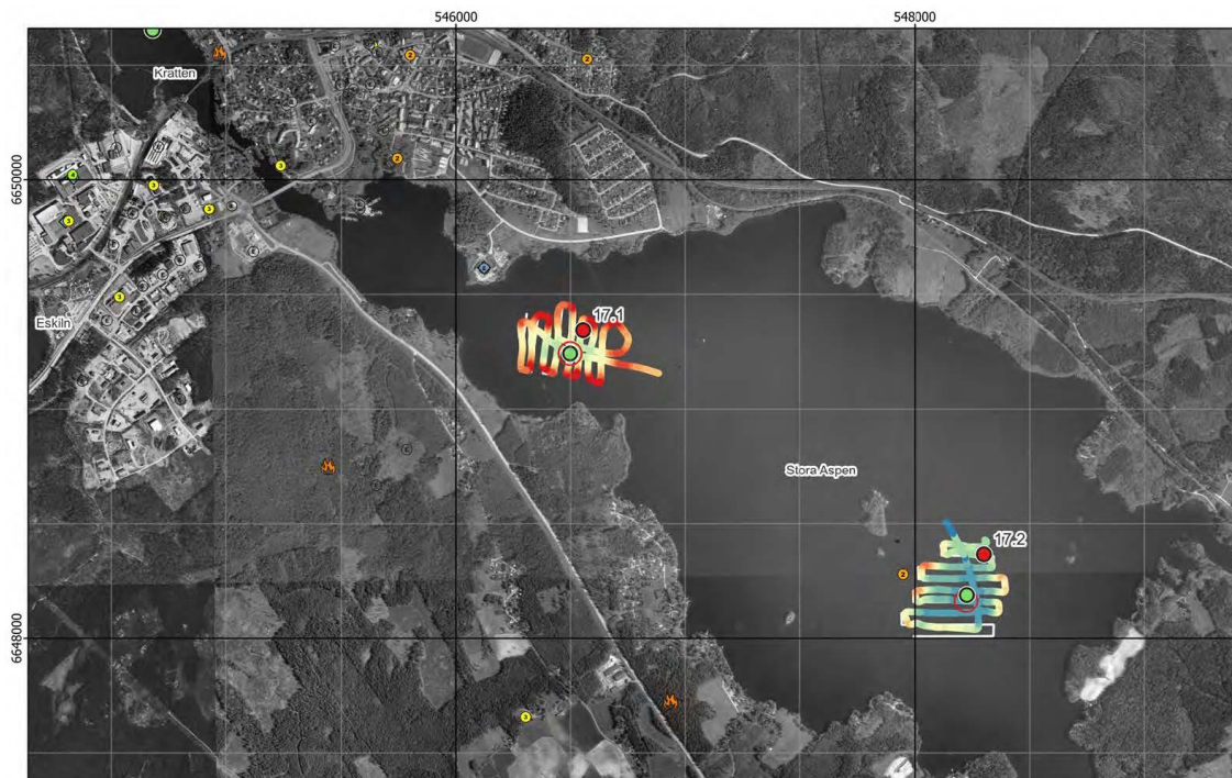
Figur 75. Karta från undersökning med enkelstrålande ekolod i sjön Stora Aspen, Västmanland. Bilden visar ortofoto från 2001 med utritad körsträcka från ekolodsmätningen (relativ färgskala för djup: rött = grunt, blått = djupt), föreslagna provlokaler (röd punkt) och slutliga provpunkter (grön punkt). Kartan visar även riskklassade förorenade områden (EBH-objekt) och områden där släckning med brandskum genomförts (eldsymboler) på land. (SGU 2023)
