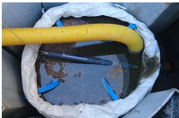
Figur 4. Pågående spårämnesförsök med sonden som mäter rhodaminhalten i det utgående vattnet.
