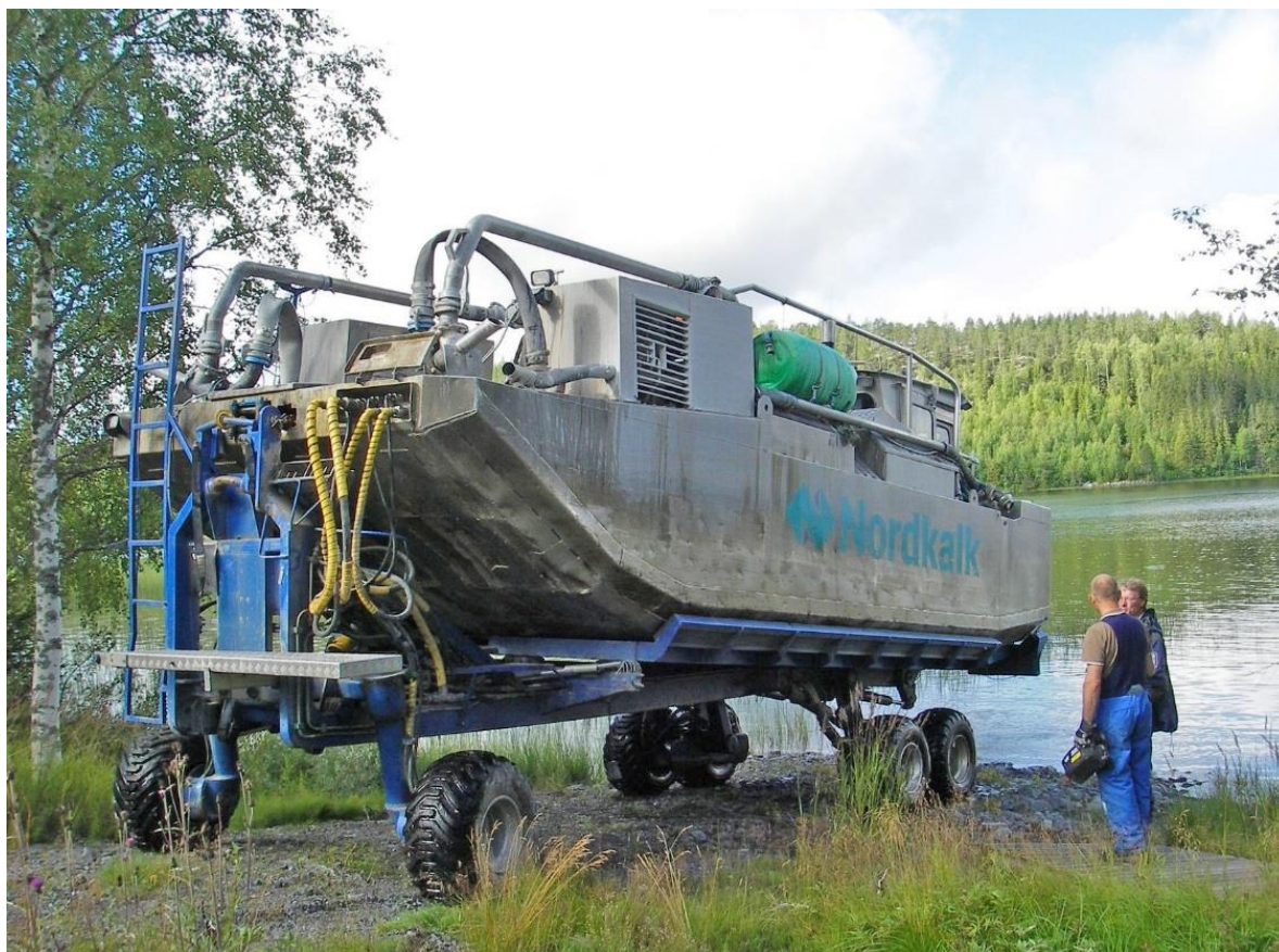
Kalkbåten "Brahe" är specialbyggd för att sprida kalk. Den går för egen maskin i och ur sjön. Brahe-båtarna byggdes 1995 och 2000 och är de modernaste fartygen för kalkspridning. Lastkapaciteten uppgår till 11,5 ton, vilket ger en spridningskapacitet på ungefär 200 ton/dag. Foto: Lajla Lindgren.
