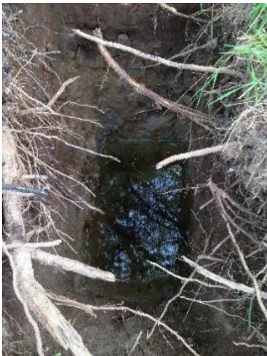
Bild 21 Provgrop för bestämning av avstånd till grundvattennivå. En provgrop bör helst vara ca 2,5 m djup alternativt grävas ner till berg eller grundvattenyta. Det observerade avståndet till grundvattenytan behöver justeras beroende på bland annat fyllnadsgraden i magasinet då observationen gjordes. Foto: Kungsbacka kommun
