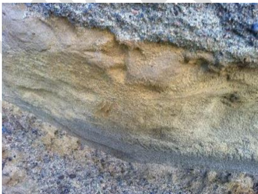
Bild 41. Det är det minst genomsläppliga lagret som är avgörande för infiltrationskapaciteten. I det här fallet ligger ett lager finkornigare material mellan två grövre lager. Foto: Kungsbacka kommun
