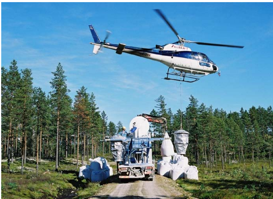
Kalken transporteras till lastplatserna i trycktank eller i storsäck (1,5 ton). När storsäck används behövs en specialtillverkad konverteringsanläggning för att överföra kalken till helikopterns spridningsbehållare. Foto: Airlift Helicopter AB.
