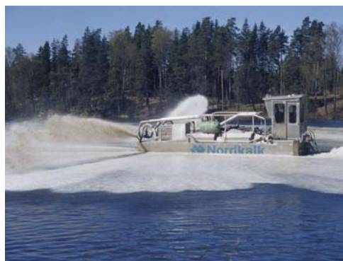
En modern kalkbåt har en hjulförsedd ramp för att enkelt komma i och ur sjöarna. Blandningen av kalk och sjövattnen sprids 15–20 meter åt varje håll från båten. Foto: Lajla Lindgren (t.v.) och Tobias Haag (t.h.).
