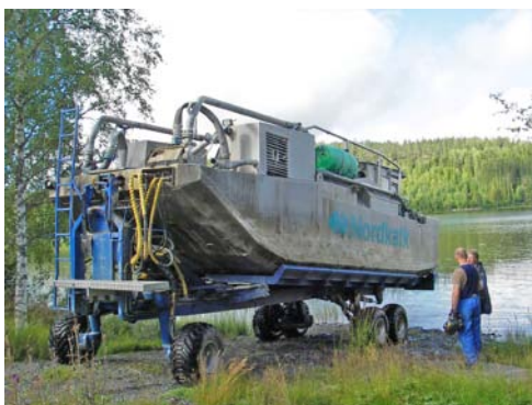
En modern kalkbåt har en hjulförsedd ramp för att enkelt komma i och ur sjöarna. Blandningen av kalk och sjövattnen sprids 15–20 meter åt varje håll från båten. Foto: Lajla Lindgren (t.v.) och Tobias Haag (t.h.).
