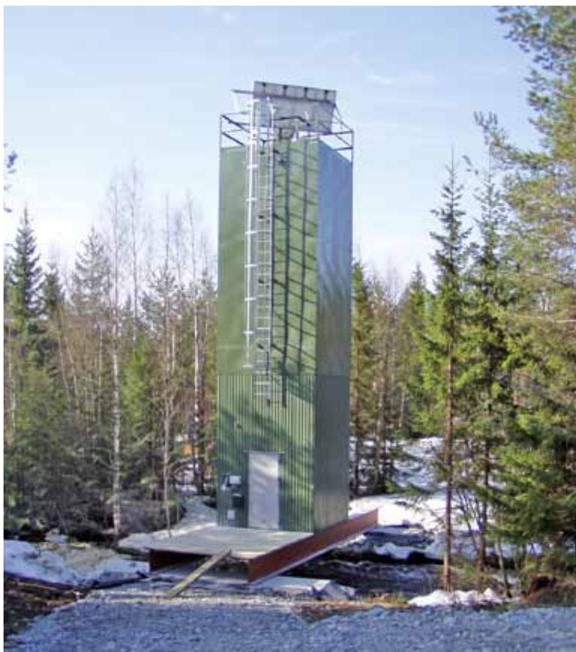
Kalkdoserare används för kalkning direkt i rinnande vatten. Under år 2008 spreds cirka 30 000 ton kalk med doserare (23 % av den totala mängden). Källa: Naturvårdsverket. Fotot visar en batteri-driven torrdoserare med laddning via solpaneler.
