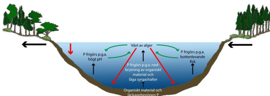
Figur 9. En förenklad version av fosforkretsloppet i helt omblandade och polymiktiska, svagt skiktade sjöar. De svarta (pilar med riktning från botten till toppen) linjerna visar bruttointernbelastning, de röda (pilar med riktning från toppen till botten) sedimentation av fosfor och de gröna (cirkulära pilar) algernas användning av fosfor från interna källor.
