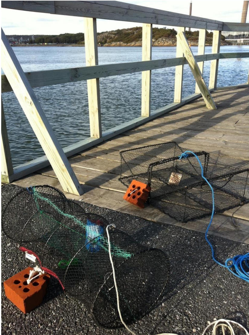
Bild 5. Redskap för provtagning av mobil epifauna enligt Helcom, Aliens 3-projektet (till vänster mjärde, till höger en bur av modellen Chinese crab trap).
