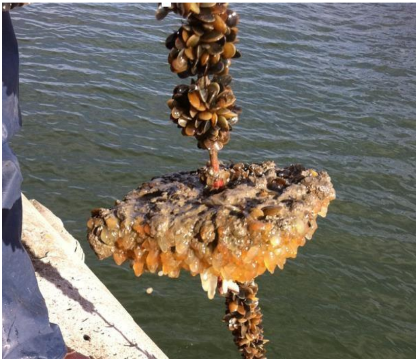
Bild 4. Påväxtpanel efter 3 månader (juli–september) i Göteborgs yttre hamn med påväxt av sjöpungen ( Ciona intestinalis ) och blåmusslor ( Mytilus edulis ).
