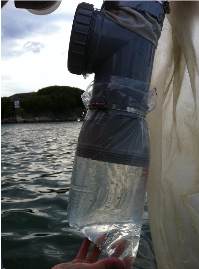
Bild 2. Modifierad botten på zooplanktonhåv för provtagning av gelatinösa plankton (bottennätet, uppe till vänster, sitter ovanför uppsamlingsbägaren/plastpåsen)
