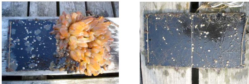
Fig. 1 Platta från Tjärnö i augusti 2011 (t.v.), jämförs med platta från Stockholm i september 2010 (t.h.). Den vänstra sidan av varje platta har rengjorts ca var 14e dag, medan den andra halvan inte har rengjorts alls under säsongen.
