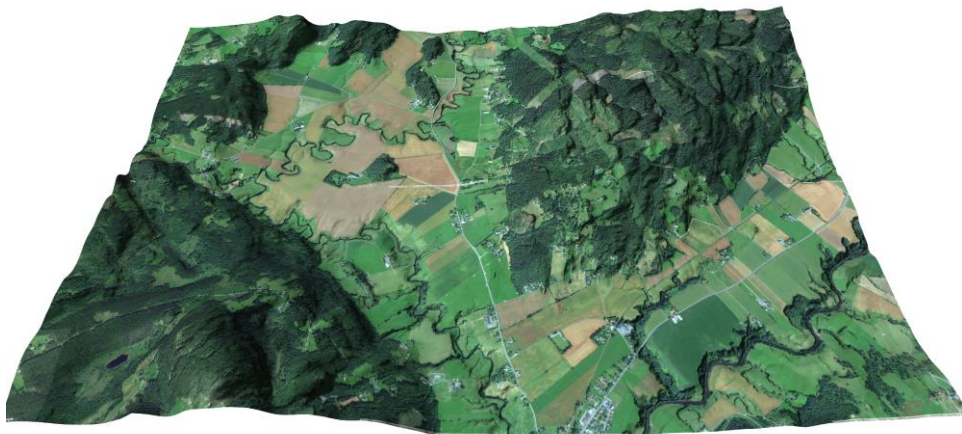
Figur 1. 3D -terrängmodell över delar av vattendragen Viskan och Surtan. Berggrundsryggar och sprickdalar har haft stor styrning på hur dessa vattendrag formats. Jordarterna i dalgången är lättroderade samtidigt som dalgångarna är breda. Detta har möjliggjort att det har bildats meandrande vattendrag.
