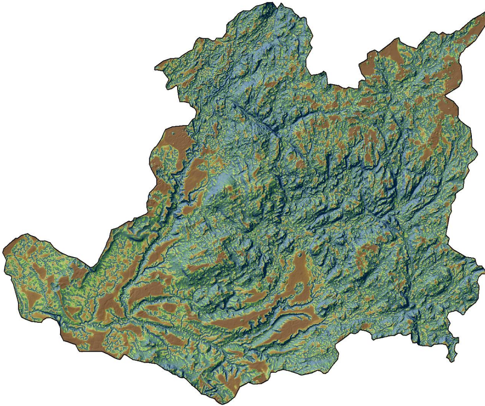
Figur 23. Identifierade platåtor inom Genevadsåns avrinningsområde beräknade med hjälp av metoden MRRTF pålagrat på ett terrängskuggat skikt.
