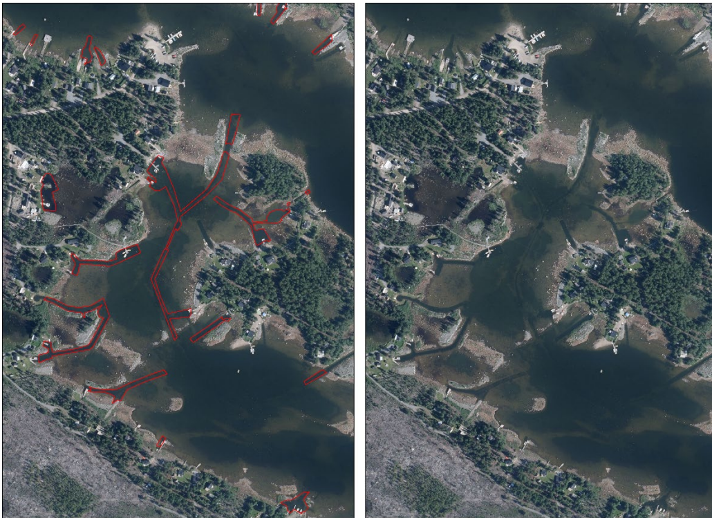
Figur 19. Till vänster visas muddringar daterad till 2012 eller tidigare i rött. Till höger visas samma bild med muddringar, utan tolkade muddringar i form av polygoner.
