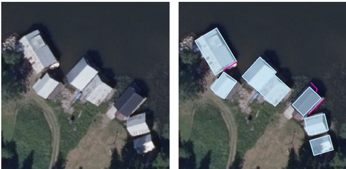
Figur 8. Byggnader har karterats i de fall då de angränsar havet. De ljusblå polygonerna markerar byggnader och de rosa linjerna är bryggor.
