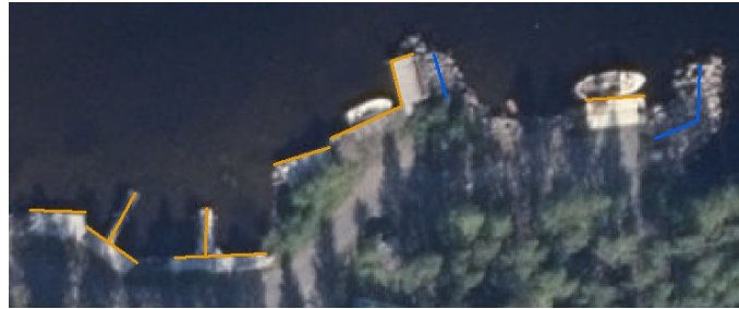
Figur 2. Orange linje markerar brygga och blå linje markerar pir. Längs strandkanten har bryggorna karterats precis i gränsen mellan land och vatten. När de sticker ut i havet har istället bryggans mittlinje karterats.
