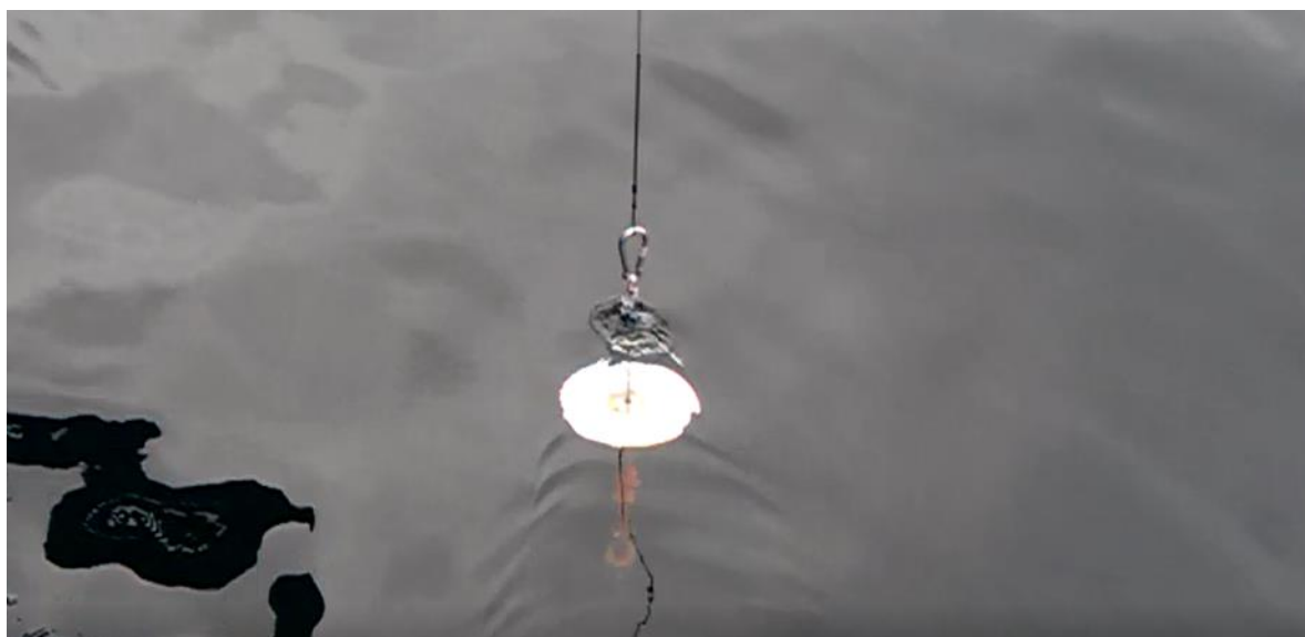
Secchi-disk för provtagning av siktdjup. Foto: Philip Axe/Havs- och vattenmyndigheten
