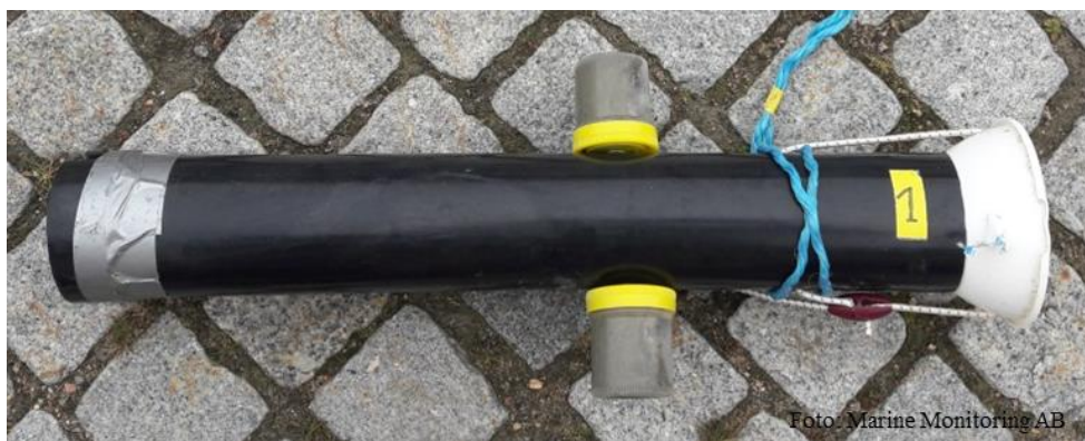
Figur 5. Bur för småkrabbor. Längd cirka 80 cm, diameter 15 cm och nätstorlek 0,5 cm.
