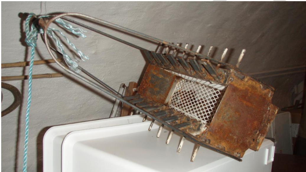
Figur 3. Karlssonkrattan utvecklat av Johan Karlsson, Calluna AB. Krattan har inga normmått. Ska en kratta av typ karlssonkratta byggas bör dock beaktas att föremål placeras vid krattans öppning (metallstift och metallplattor) som river upp framför allt isoetider (rosettbladsväxter) så att dessa fastnar i krattan. Maskdiameteren hos krattans långsidor bör inte vara större än 1 cm. Foto taget av Johan Karlsson.
