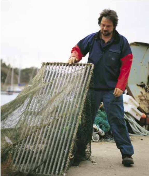
Räkfiskare från Norra Bohuslän med en så kallad rist. Risten, som sitter i trälöppningen, gör att bifångsten av fisk som exempelvis torsk blir minimal.
