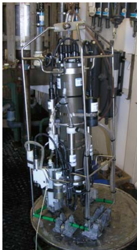
En så kallad CTD som sänks ned i vattnet och mäter djup, salthalt, temperatur och syrehalt.
