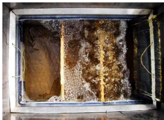
Figur 46. Reglar som minskar torktumlingseffekten i yngelfällan (foto: Jonas Nilsson).
