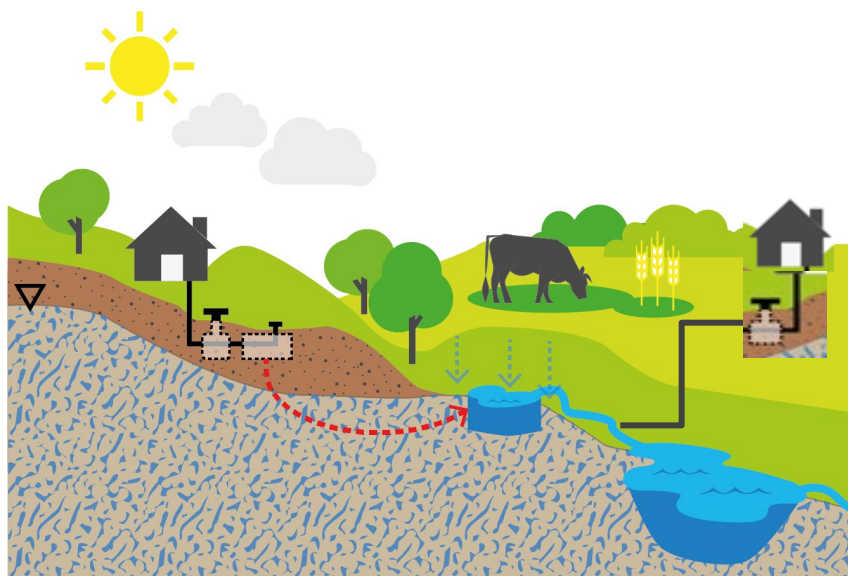
Figur 38. Schematisk bild över hur utsläpp från diffusa källor som små avloppsanläggningar och jordbruk rinner genom mark till vattendrag och sjöar. För en del anläggningstyper passerar inte avloppsvattnet mark, utan utsläppet sker till vattendrag direkt. Modellen beräknar hur mycket av näringsämnena som fastnar eller fördröjs på genom processer i mindre vattendrag och sjöar samt större vattendrag och sjöar.
